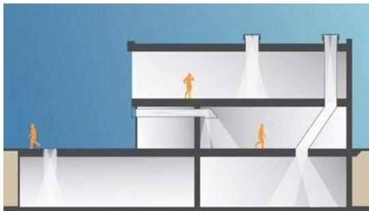
Figura 5.2. Sección de edificio con conductos de luz
