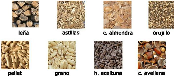
Figura 7.1. Biomasa habitualmente utilizada en instalaciones automatizadas
