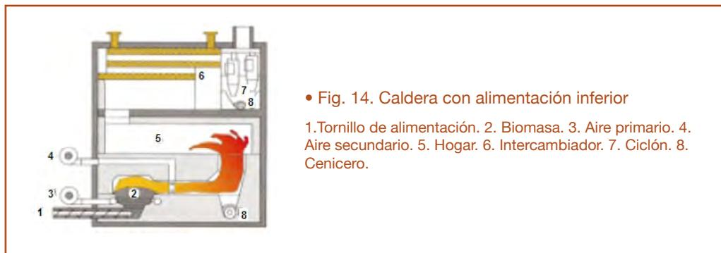
Presentan buen rendimiento con biomazas de alta calidad, es decir, poco húmedas y con bajo contenido de cenizas, como pueden ser las astillas secas, los pélets y algunos residuos agroindustriales. La combustión es lenta, estable y controlada, pues la velocidad de entrada del aire primario es pequeña (entra junto con el combustible) y la alimentación de combustible está controlada.
