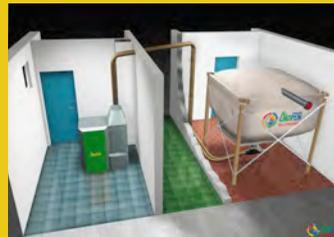
• Fig. 3: Silo flexible con sistema de alimentación neumático.
