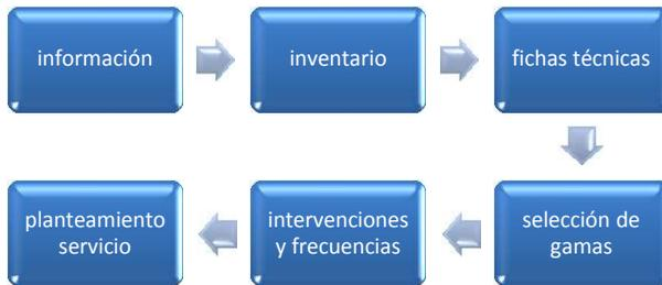
Figura 5.2. Proceso de elaboración de un Plan de Mantenimiento
