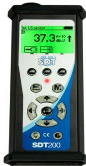
Figura 7.4. Equipo portátil de medición por ultrasonidos.
